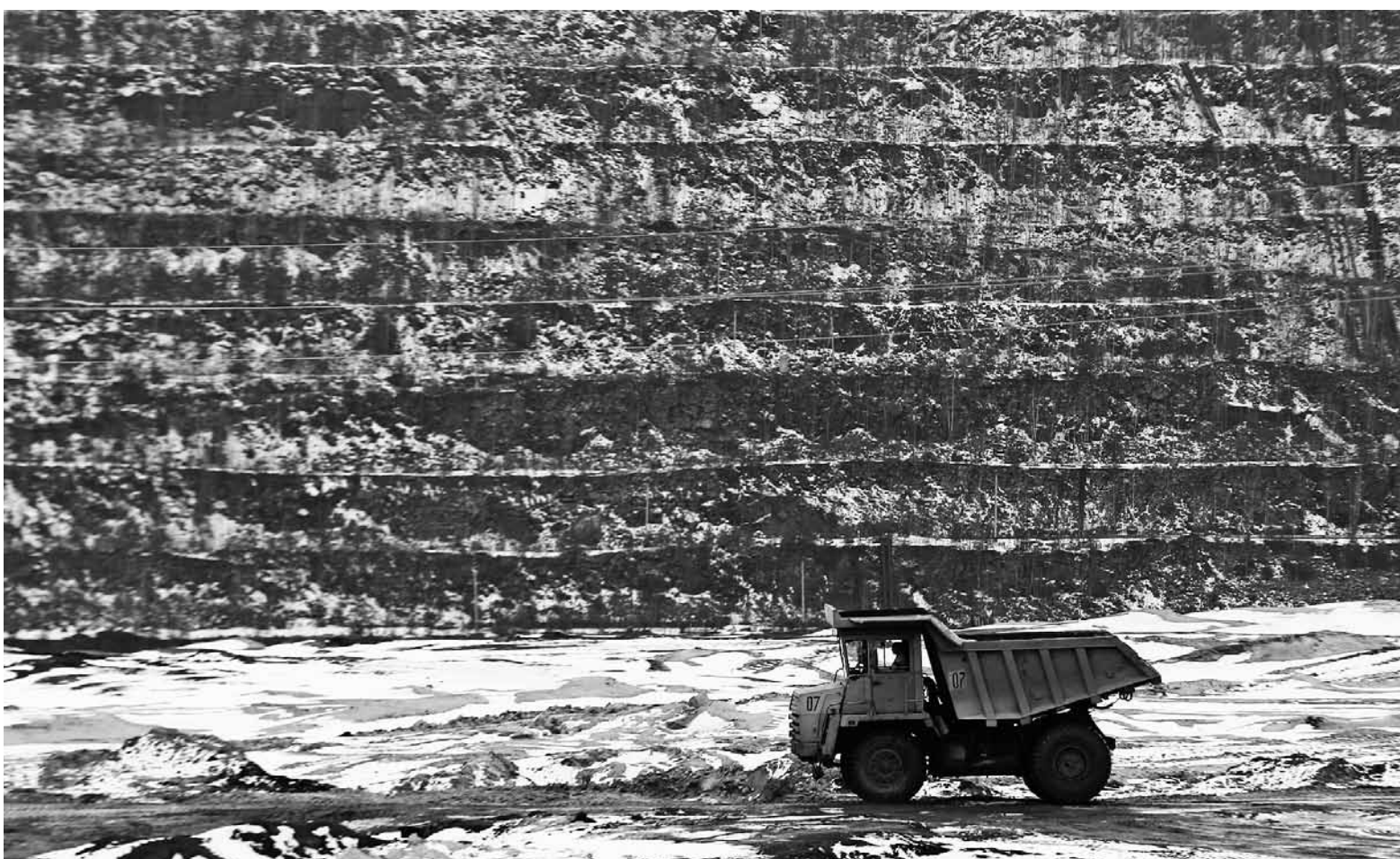
У кар'еры трынаццаць ярусаў. Каб трапіць на дно, БелАЗы праезджаюць 17 км па серпанціне.
